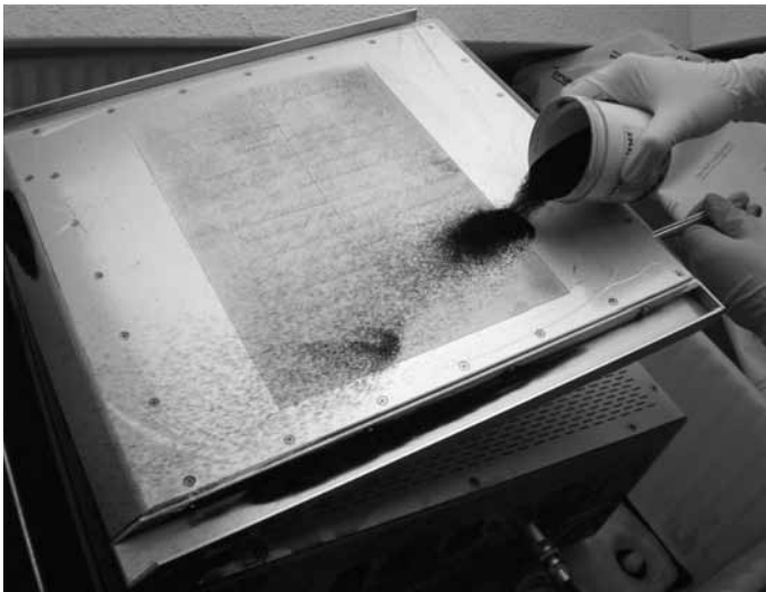
Abb. 12: Elektrostatische Oberflächenprüfung: Sichtbarmachen von Durchdruckspuren (zerstörungsfrei)
