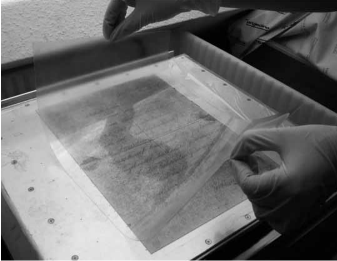
Abb. 13: Sichern der sichtbar gewordenen Durchdruckspuren mittels Folie (zerstörungsfrei)
